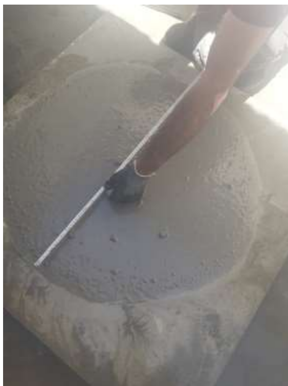
شکل 2: ارزیابی جریان اسلامپ بتن تازه مطابق با استاندارد ASTM C1116
