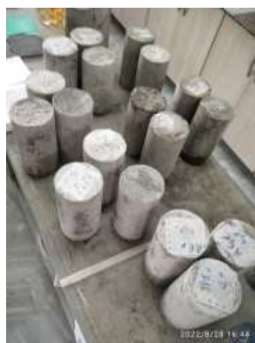
شکل 4: ارزیابی مقاومت کششی دو نیم شدن مخلوط های بتنی خود متراکم مطابق با استاندارد ASTM C496
