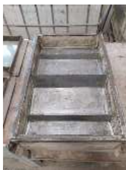
شکل ۱: قالب و ابزار فولادی مورد استفاده در تحقیق
