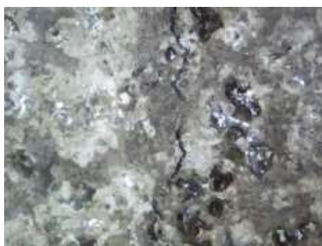
شکل ۴: تصویر دیجیتال از محل ترک خوردگی
