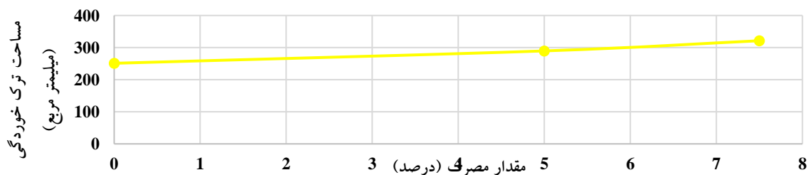
شکل ۷: تغییرات مساحت ترک خوردگی ناشی از جمع شدگی خمیری نسبت به تغییرات دوده ی سیلیس در مخلوط های بتنی
