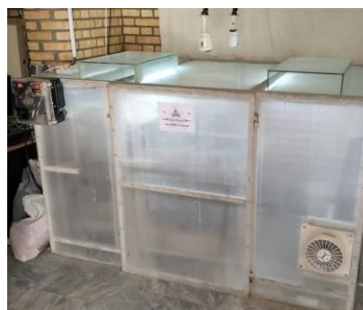
شکل ۲: محفظه ی شبیه ساز عوامل جوی مورد استفاده در تحقیق
